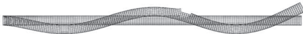
Рис. 4. Отверстие на отметке 2 м. Размер отверстия 10×10 см. Частота \omega = 323,06 Гц. (4-я форма поперечных колебаний)
